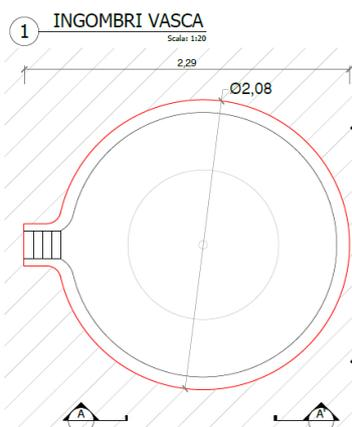
Fig. 1 – Schema dim. plan. vasca
